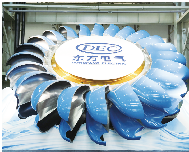
东方电气自主研制的世界单机容量最大500兆瓦冲击式水电机组核心部件“东方蓝莲”首台转轮。 东方电气集团/供图
