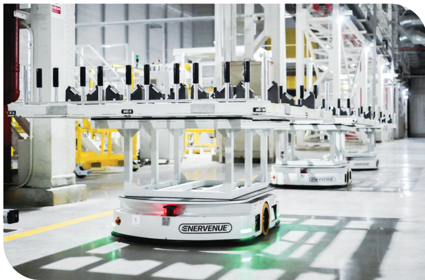
在各工位之间转运电芯的自动导引运输车(AGV)。屹创新能源/供图
