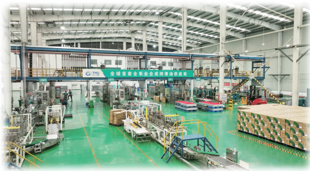
图为太行润滑科技股份有限公司自动化灌装生产线。
