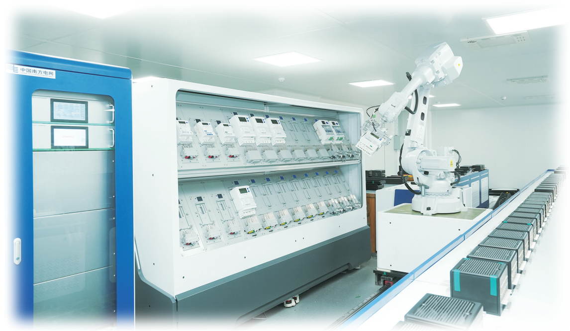
图为全国首个新型电力系统国家质检中心智能量测产品自动化检测线。南网科研院/供图
