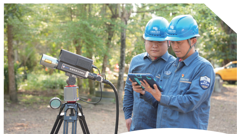
海南电网输电运检分公司工作人员使用激光清障仪处理线路树障。温婧伊/摄
