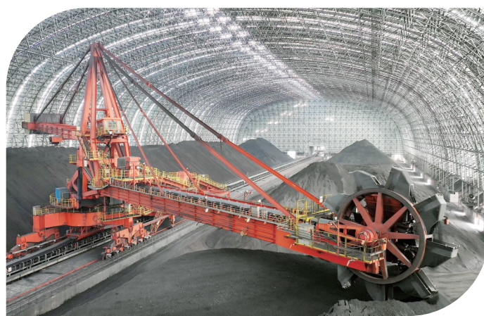
图为国家能源集团广西北海公司堆场斗轮机正在为机组上煤。王懋霖/摄
