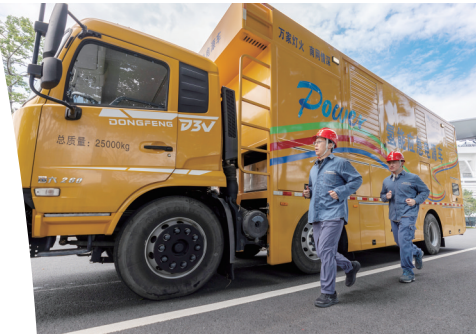
南方电网广东广州供电局为十五运保电部署的氢能应急发电车,为赛事场馆及城市生命线提供低碳可靠电力保障。
