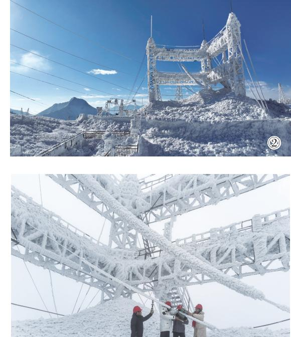
图③为国网经研院工作人员在二郎山野外站对线路覆冰进行取样实验。
