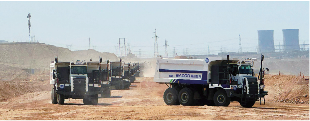
图为在露天煤矿运行的无人驾驶卡车。北京易控智驾科技有限公司/供图
