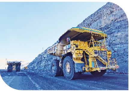
无人驾驶卡车行驶在中煤平朔集团露天矿区里。平朔集团/供图
