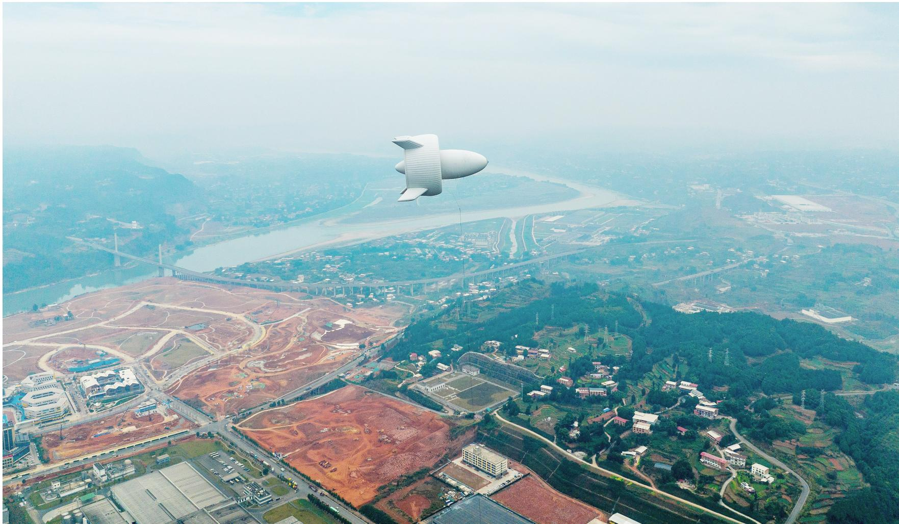
1月5日,全球首台适用于城市环境的兆瓦级S2000浮空风力发电系统(SAWES),在四川省宜宾高新区成功放飞至2000米高空,并累计顺利发电385千瓦时,同时完成并网发电测试。
