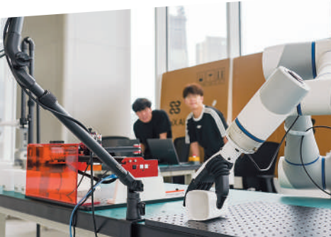
▼在杭州机器人学校，激光雕刻+自动上下料的最小系统正在进行初步测试。郭扬摄
