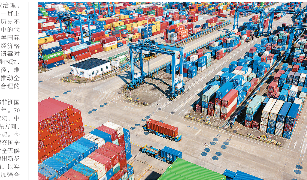
“无人集卡”是搭载“5G+AI”的自动驾驶集装箱卡车，能实现装卸、运输、收箱等环节的全程无人化和智能化调度，提升港口作业效率。 图为“无人集卡”在江苏南通港通海港区码头运送集装箱。 许丛军摄（人民图片）
