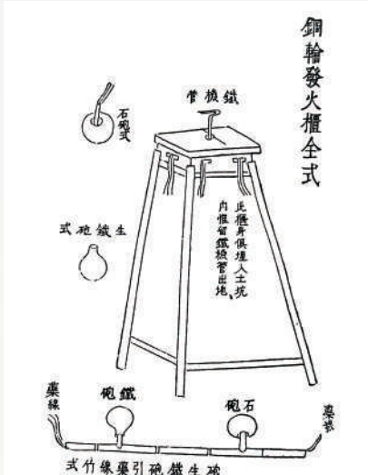
上二图：明代《武备志》记载的引爆地雷的钢轮发火装置。
