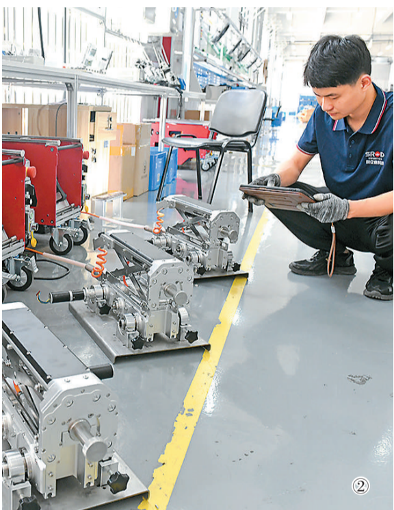
图①：在湖北省宜昌市秭归县，技术人员正在操作管道检测机器人，为地下排水管网开展汛期“全身体检”。彭强摄（人民视觉） 图②：安徽淮南经济技术开发区的一家科技公司内，工人在对智能巡检机器人进行调试，该款机器人广泛应用于排水、供水、燃气、热力等“城市生命线”巡检。陈彬摄（人民视觉）
