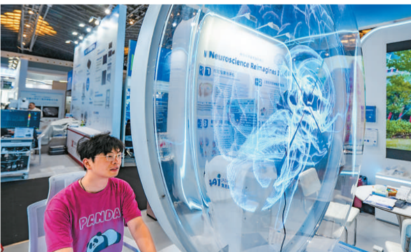
一台用高速旋转扇叶的投影设备，呈现出人脑的立体旋转图像。
