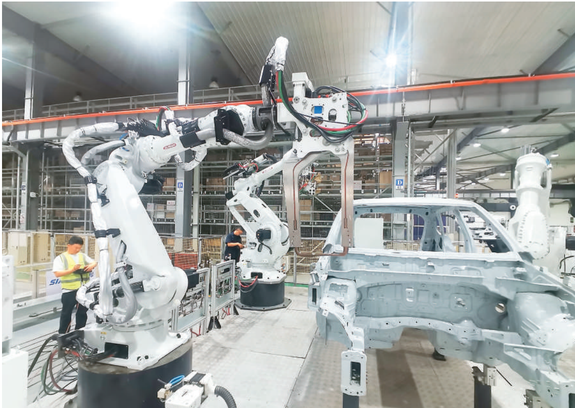
◀ 图为6月2日，沈阳新松车间内，工作人员正在对国产焊钳电机点焊工作站的设备进行调试。
