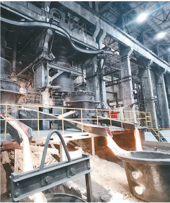
图为沈阳工业博物馆展出的十吨冲天炉。
