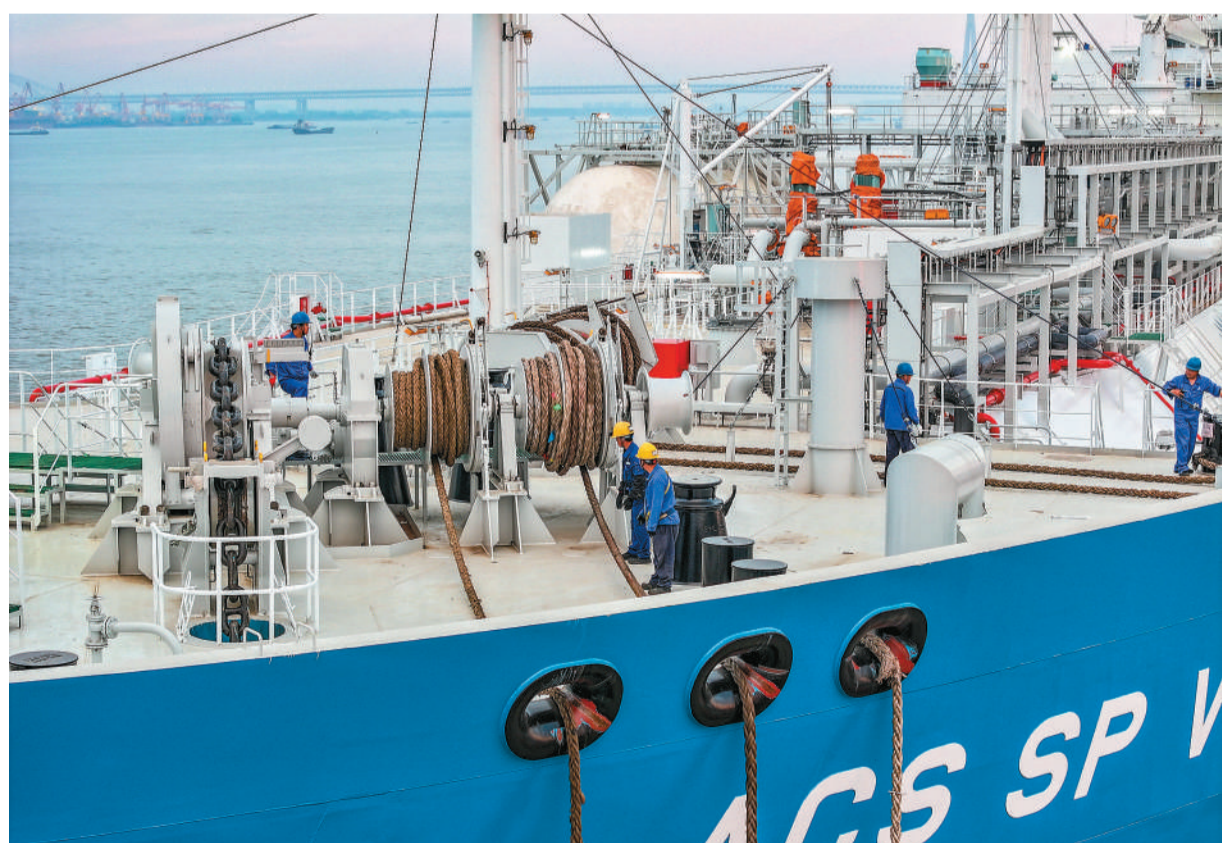
5月8日,由江苏扬子鑫福造船有限公司自主建造的超大型乙烷运输船“鑫福137”轮,在泰州海事部门全程保障下,于江苏省泰兴市出江试航。该轮总长229.9米,型宽36.5米,舱容达10万立方米。图为“鑫福137”轮停靠江苏扬子鑫福造船船坞码头,试航船员收缆准备启航。 顾继红摄(新华社发)
