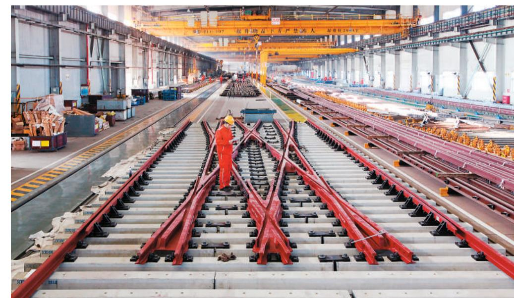
▲ 工人对出口智利的铁路道岔进行厂内试铺。
