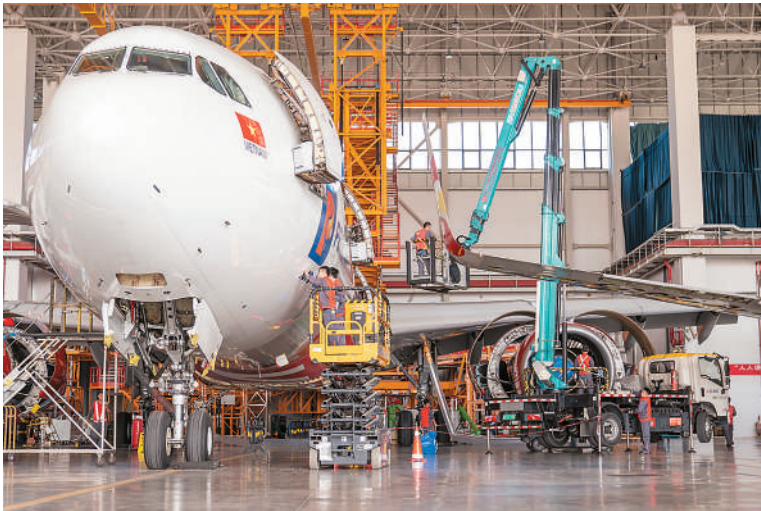
海南自贸港一站式飞机维修产业基地自2022年投产以来，截至今年10月底，已完成超2400架次飞机维修、超280架次整机喷涂及6.1万件航空零部件维修，服务覆盖国内外近50家航空公司及飞机租赁公司。图为近日，海航技术旗下大新华飞机维修服务有限公司的机务维修人员对进境飞机进行检修。 新华社记者 张丽芸摄
