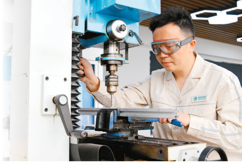
何涛在工作室操作铣床加工无人机零部件。
