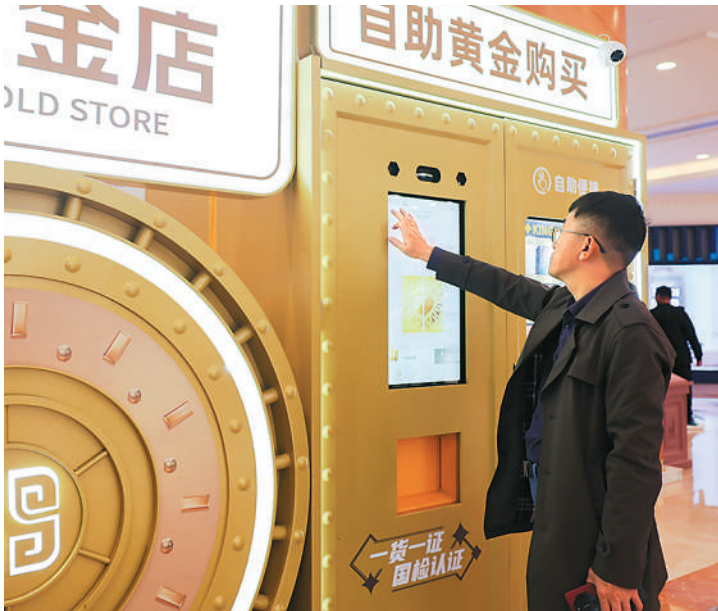
上海市普陀区一家金店设置了黄金购买回收自助设备。该设备可实现“智能回收”，具备自助下单、自动检测、快速回款等功能，系统可自动检测用户放入的黄金重量和纯度，根据实时金价计算回收金额并迅速打款。 新华社记者 王翔摄
