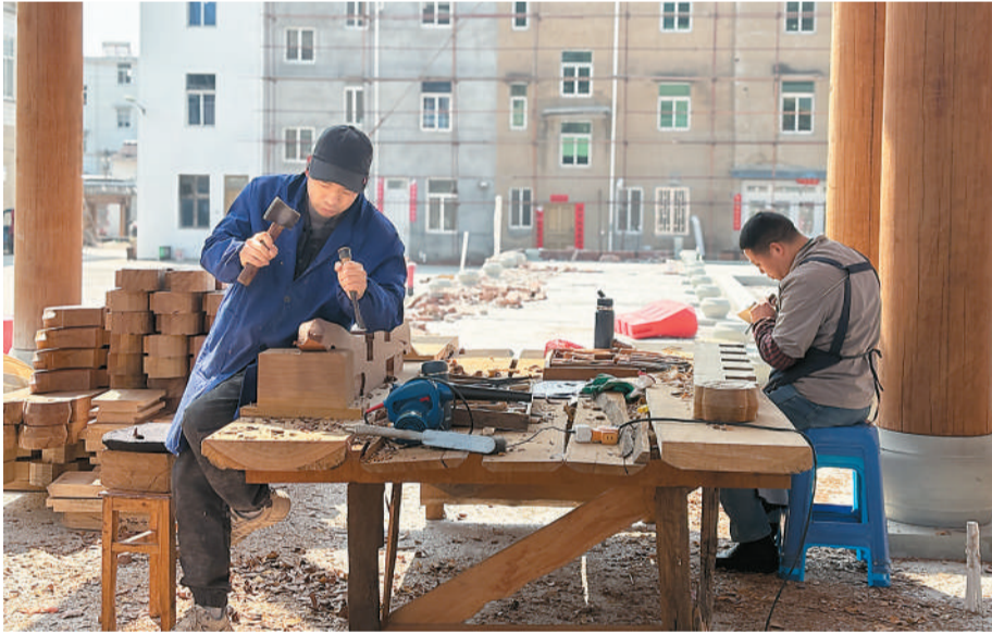
2025年3月20日，在汇溪镇浚头村，工匠们在制作仿古建筑构件。梁蕙薇摄
