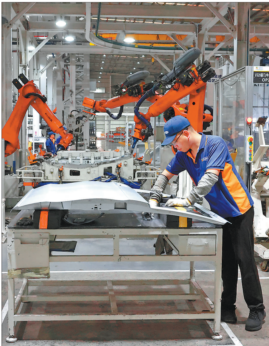
福建福州一家企业生产车间内，工人在生产汽车车身钣金件产品。
