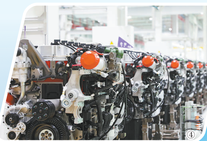
图①：工人在东风康明斯重马力发动机工厂装配线作业。 图②：等待下线入库的M15发动机。 图③：工人在东风康明斯重马力发动机工厂装配线安装喷油器。 图④：即将进行出厂试验的Z15N天然气发动机。 底图：康明斯东亚研发中心外景。
