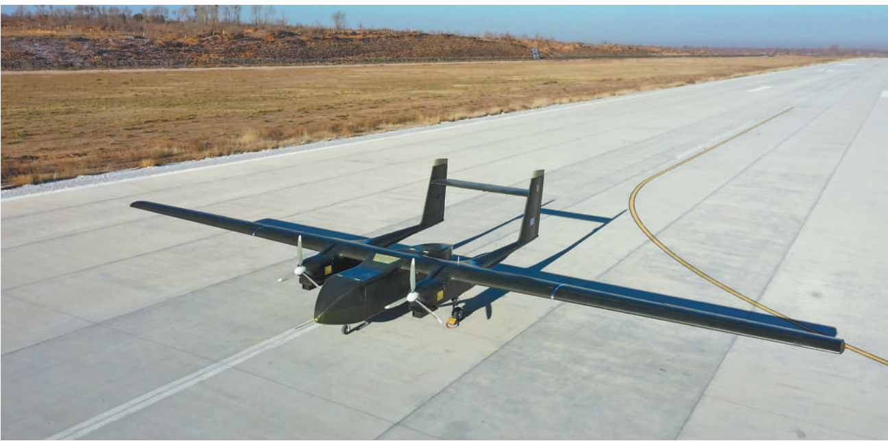
1月11日,我国自主研发的“天马—1000”无人运输机顺利完成首飞试验。该机型最大航程1800公里、最大载重1吨,集物流运输、应急救援、物资投送等多功能于一体。图为完成首飞的“天马—1000”降落在跑道上。 李心萍 王 京 摄影报道
