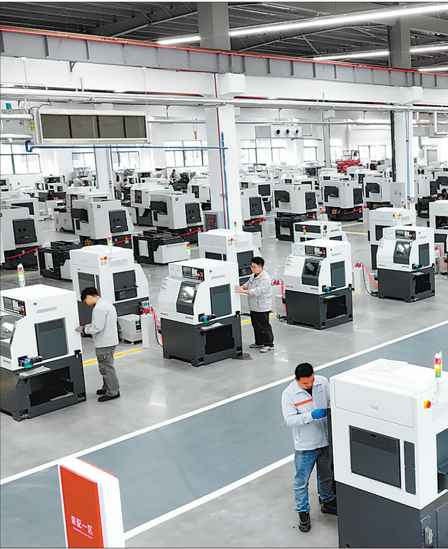
湖北通城经济开发区一家企业的数控机床组装车间内，技术人员对自主研发的高端数控机床进行调试。 刘建平摄(人民视觉)
