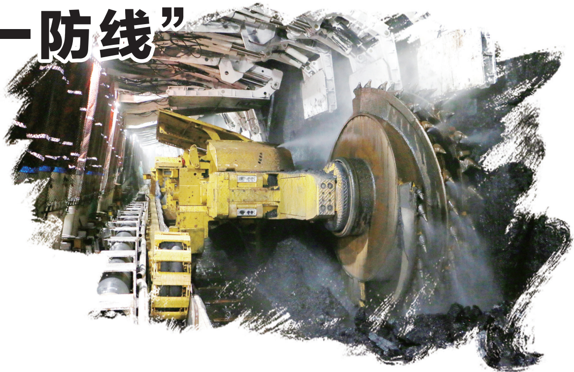
图为陕西大海则煤矿井下采煤机割煤场景。中煤陕西公司/供图
