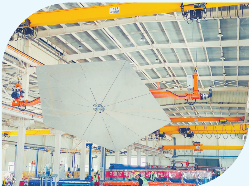
东方数科建设的国内首条抗超高速定日镜智能组装机。
