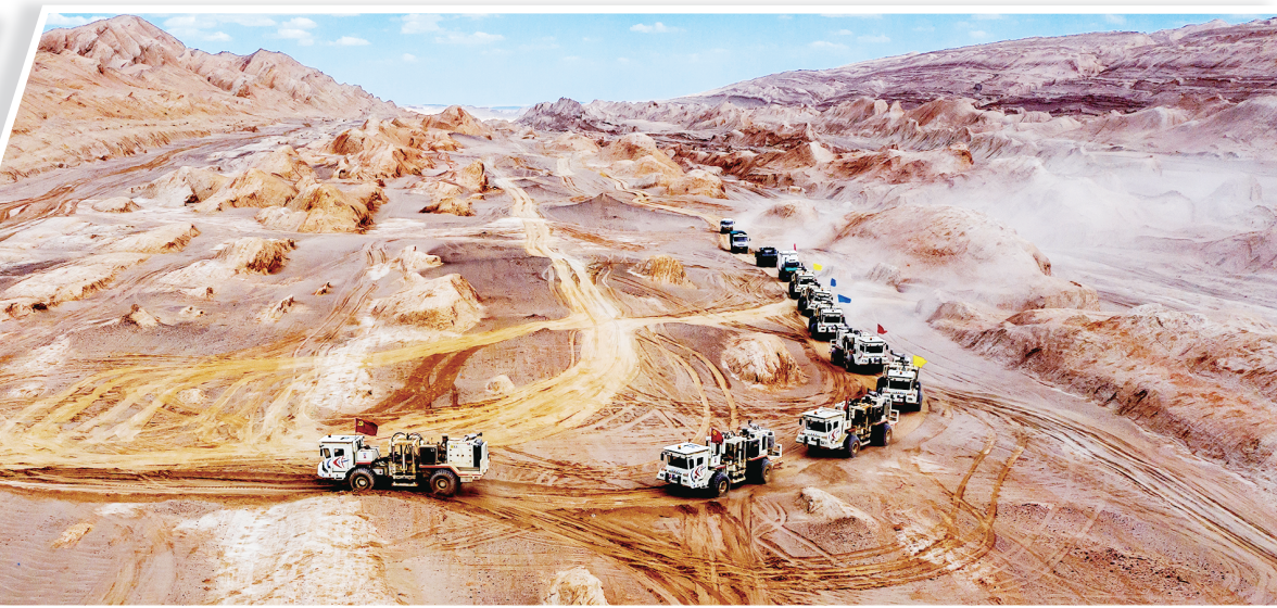
图为中国石油东方物探公司三维智能化全波形反演数据采集现场,使用宽频大吨位可控震源在青海探区作业。
