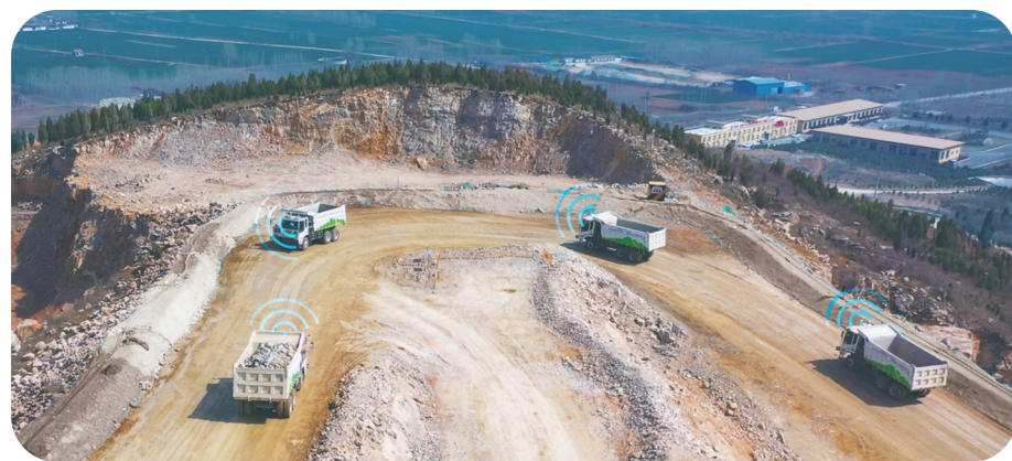
纯电无人矿卡在山东宏河百利邹城危山矿实现常态化运行。易控智驾/供图
