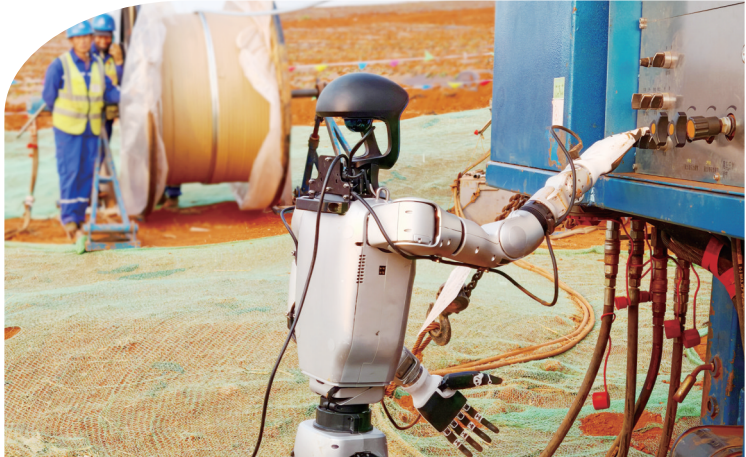
图为入形机器人操作张力机手柄。
