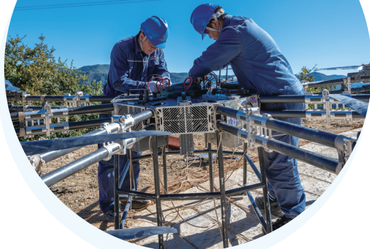
▲图为工作人员在500千伏苗新乙线检修过程中,对用于运输材料的重载无人机进行起飞前检查。
