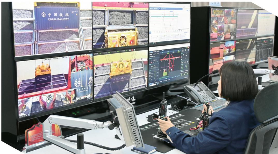
图为济宁龙拱港工作人员通过远程操控平台进行装卸作业。杨沐岩/摄
