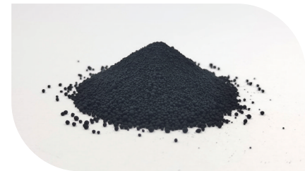
图为110kV、220kV电缆超光滑半导电屏蔽料用导电炭黑。南网科研院/供图
