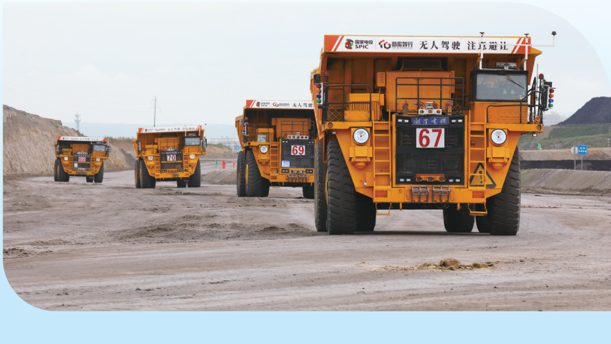
▲图为国家电投内蒙古公司南露天煤矿投入使用的无人驾驶矿用宽体矿卡。
