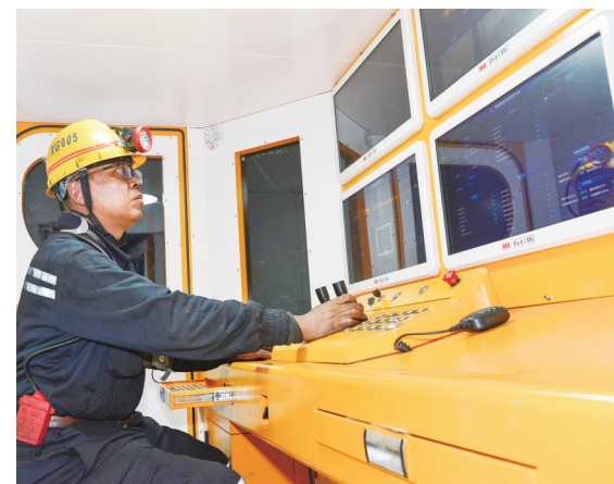
图为晋能控股装备制造集团赵庄煤矿引进的山西省首台EBZ—280M型智能掘锚一体机。
