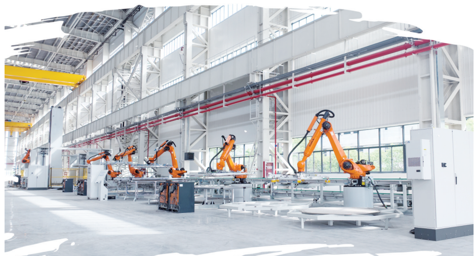
图为已投运的阳光氢能国际领先碱性电解槽自动化装配产线。阳光氢能/供图
