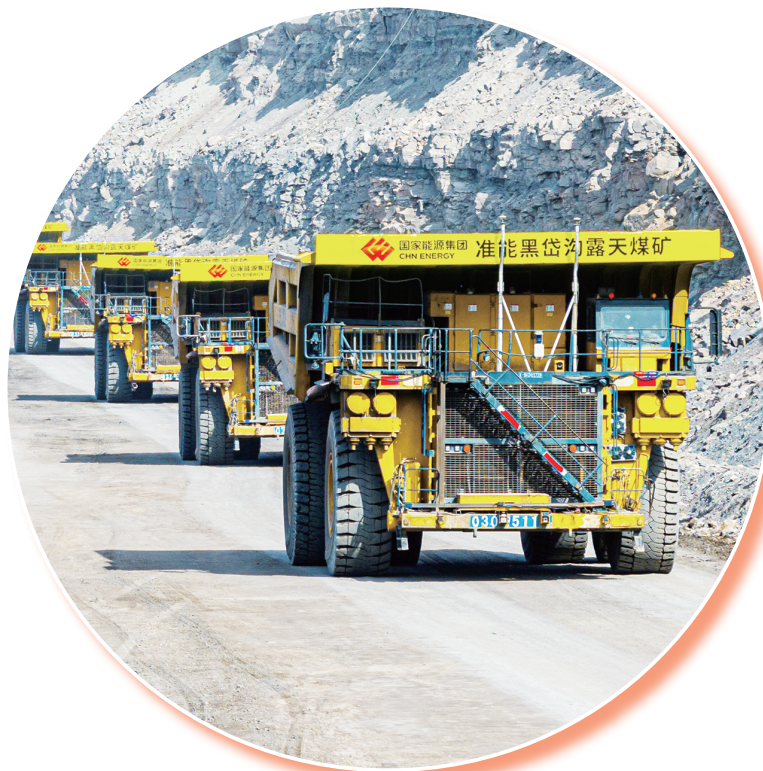
图为作业中的国能准能集团黑岱沟露天煤矿无人驾驶矿用卡车。包文学/摄
