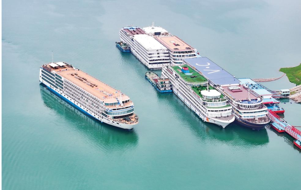
9月13日，长江新一代绿色电力顶级豪华游轮“世纪远航”号从重庆朝天门码头启航，9月16日抵达湖北省宜昌市秭归旅游港口，完成三峡首航。该游轮全长149.99米，总吨位1.5万吨，可载客650人，采用绿色智能电力推进，全新配套升级，实现了客房、餐饮服务和科技方面的全新突破，是目前最先进的长江游轮，极大促进长江三峡游轮旅游的高质量发展。 人民图片
