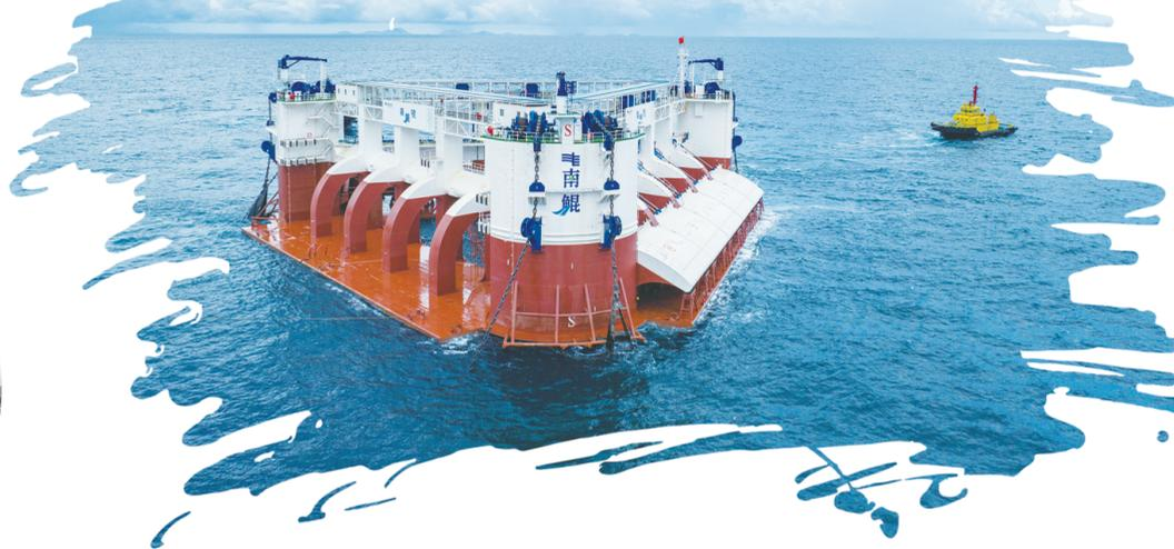
图为世界首台兆瓦级漂浮式波浪能发电装置“南鲲”号,日发电量相当于3500户家庭1天的用电量。 南方电网/供图
