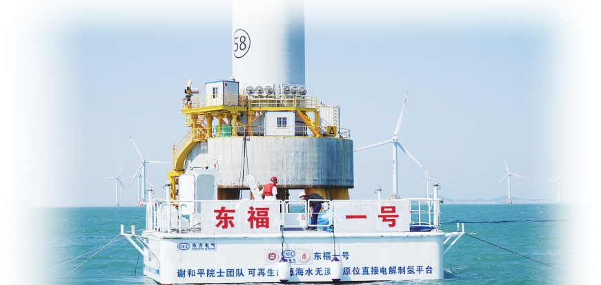
可再生能源海水无淡化原位直接电解制氢平台“东福一号”，在真实海洋环境下持续稳定运行240小时。郭雨婕/摄
