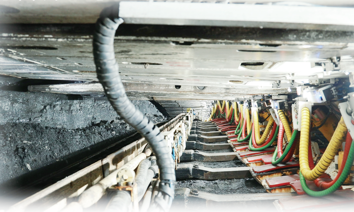
杨村煤矿的薄煤层开采工作面
