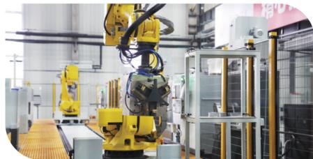
机器人正在配送核心零部件准备进入对比仪,进行全方位检测。
