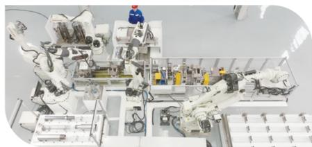
四台6轴机器人正在协助作业进行“海弘”系统产品的智能装配作业。
