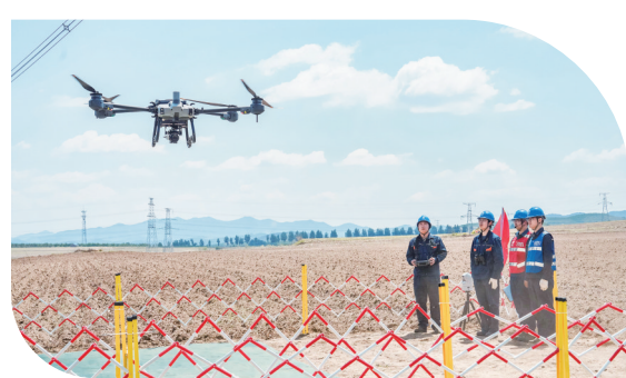
国网辽宁电力人员利用无人机载X光带电探伤技术对鞍山500千伏唐王二线97下相悬垂线夹进行检测。赵琦林/摄
