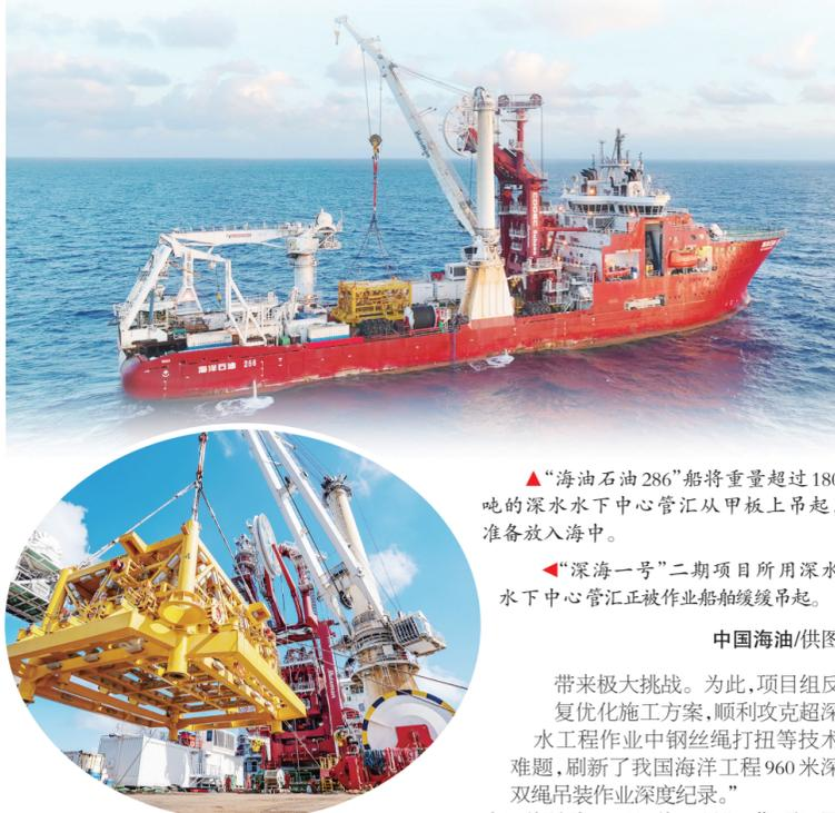
▲“海油石油286”船将重量超过180吨的深水水下中心管汇从甲板上吊起,准备放入海中。
