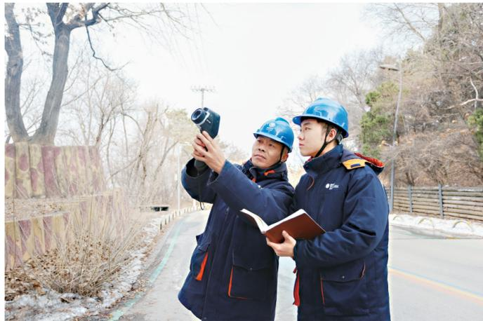
国网沈阳供电公司员工检测位于山区的10千伏线路连接点温度。陈龙/摄
