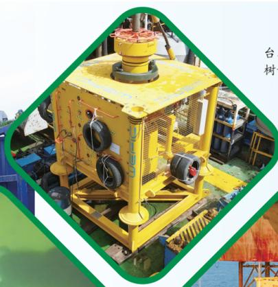
▲在“南海7号”钻井平台现场,作业人员进行注水树设备功能检查。
