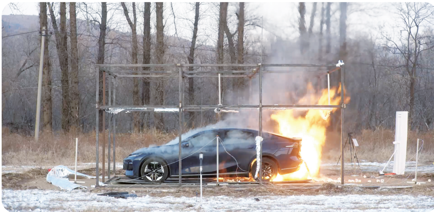
氢燃料电池整车极限火烧试验过程中。中国汽研/供图
