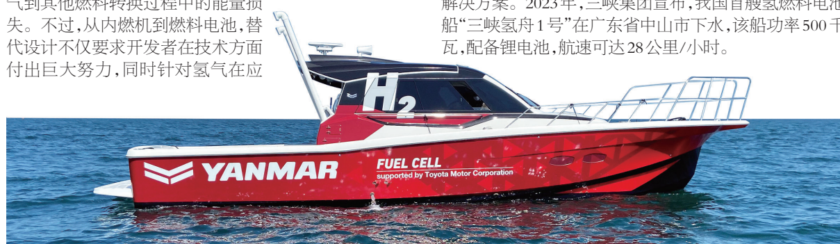
洋马公司配备船用燃料电池系统的原型船。
